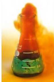
Attaque du cuivre par une solution d'acide nitrique concentré
